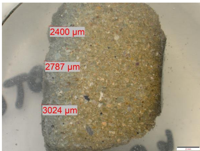
Obr. 5 Makrosnímky kolmého řezu vzorku MaCoTe: měření alterované vrstvy bentonitu
