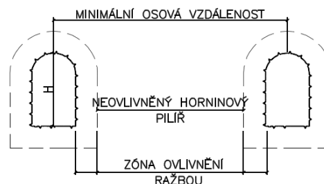
Obr. 52 – Princip stanovení minimální vzdálenosti mezi zav. chodbami / ukládacími vrtů
