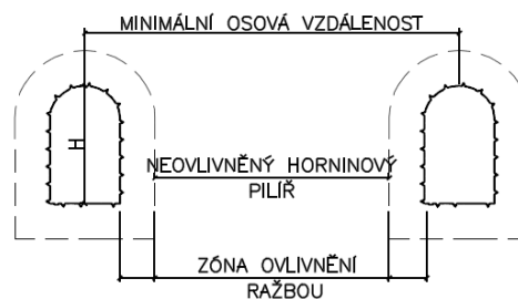
Obr. 51 – Princip stanovení minimální vzdálenosti mezi zav. chodbami / ukládacími vrty
